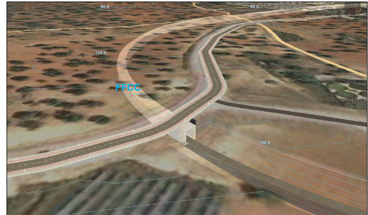
Imagen virtual 3. Vista 3D del cruce de la línea ferroviaria con la carretera del Parc BIT
